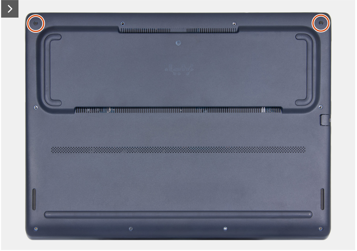
Rakam 12. Alt kapaktaki tutucu vidaları gevşetme
